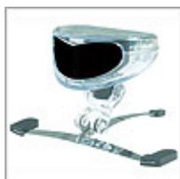
Dispositivo compuesto por una plaquita refractaria y una cámara infrarroja que se coloca sobre el monitor. Está pensado para las personas que no pueden utilizar sus miembros superiores pero que sí puedan tener una adecuada coordinación con la cabeza. La plaquita se coloca sobre un gorro o en las monturas de anteojos y con el movimiento de la cabeza se determina el movimiento del cursor sobre la pantalla.
